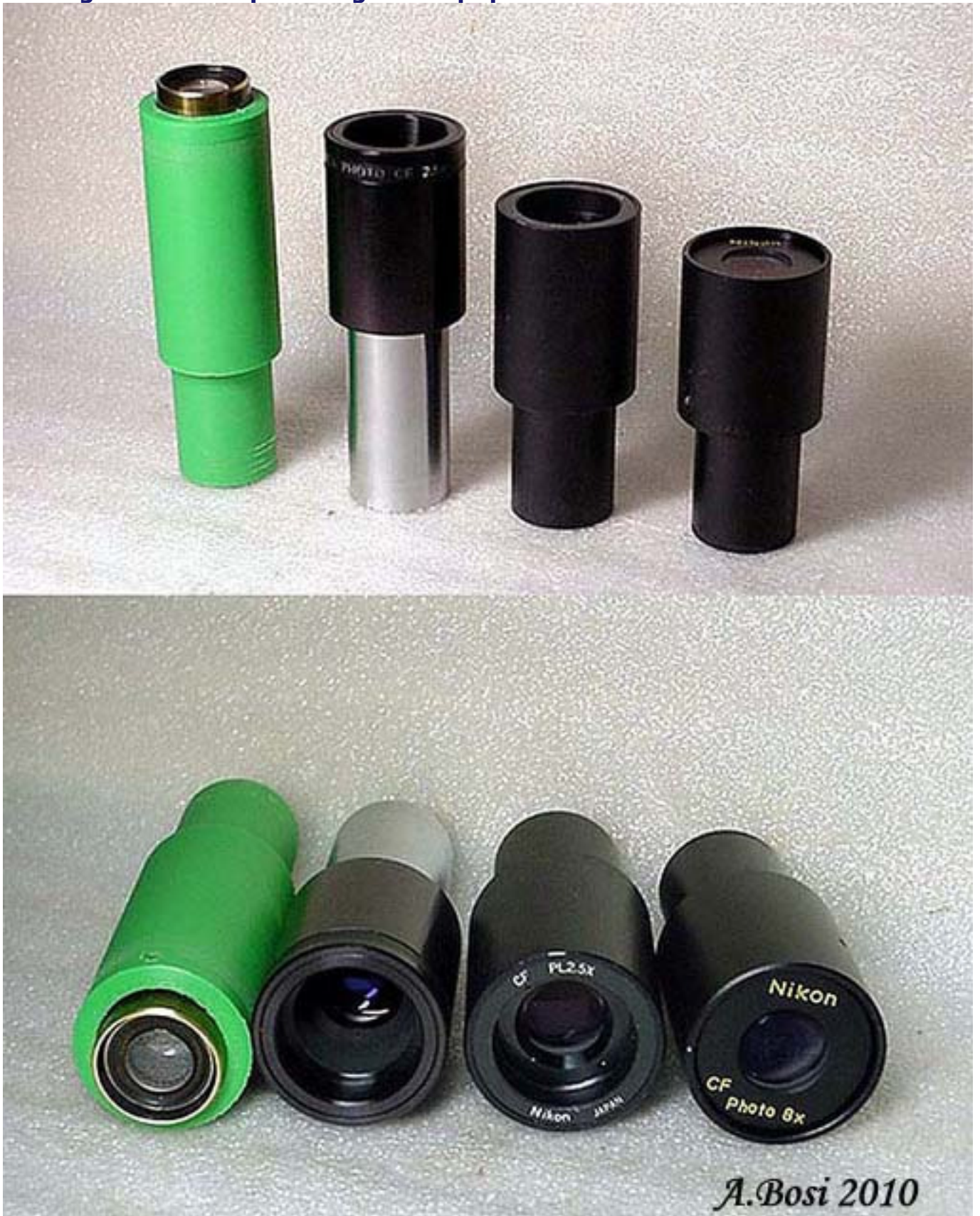
Immagine: Oculari per fotografia a pupilla alta da 25 a oltre 55 mm.
